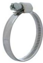
Fascette stringitubo a vite tipo **W4 con vite, carter e nastro in acciaio inox AISI 304**. Con anello a cremagliera stampata e bordi arrotondati per evitare danneggiamenti al tubo, carter con dimensioni ridotte per favorire maggior flessibilità nell'adattamento alla circonferenza del tubo, chiusura del carter con punto di saldatura e perfetto accoppiamento vite/cremagliera in bagno di grasso per garantire alte prestazioni in fase di serraggio.
