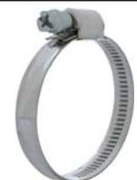
Fascette stringitubo a vite tipo **W2 con vite in acciaio zincato, carter e nastro in acciaio inox AISI 430**. Con anello a cremagliera stampata e bordi arrotondati per evitare danneggiamenti al tubo, carter con dimensioni ridotte per favorire maggior flessibilità nell'adattamento alla circonferenza del tubo, chiusura del carter con punto di saldatura e perfetto accoppiamento vite/cremagliera in bagno di grasso per garantire alte prestazioni in fase di serraggio.
