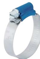
Fascette stringitubo a vite tipo **W1 con vite, carter e nastro in acciaio zincato**. Nastro laminato con bordi rialzati e superficie interna liscia, carter con base corta realizzato mediante un processo di saldatura automatizzata ad alta precisione, verniciato blu. Questa fascetta mantiene la rotondità e la tenuta anche sui piccoli diametri. Esagono vite 7 mm.
