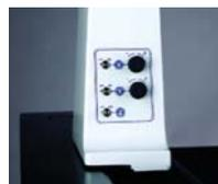
Blocchi assi X, Y e Z e regolazione fine in posizione centrale degli assi X e Y.
