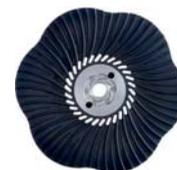
Platello per l'uso dei dischi fibrati Combiclick® su smerigliatrici angolari. La geometria dei canali di raffreddamento permette un costante passaggio di aria che minimizza l'effetto di riscaldamento dell'utensile e del pezzo.
