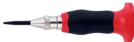
Bulino automatico per meccanici, corpo in acciaio nichelato con impugnatura di protezione bimeriale, battuta a scatto tramite dispositivo caricato a molla con profondità di incisione regolabile mediante regolazione della vite zigrinata, punta in acciaio temprato riaffilabile e sostituibile.
