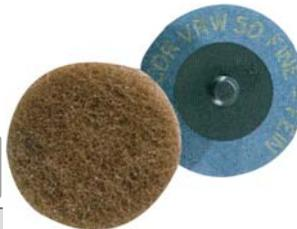
Disco abrasivo COMBI DISC - Sistema CDR al **corindone Vlies esecuzione tenera** adatto per finitura di superfici, profili e per la pulitura su tutti i metalli e vernici. L'uso dell'olio o dell'acqua durante la smerigliatura consente di ottenere superfici migliori e migliorare la durata dell'abrasivo. Compatibile con altri sistemi presenti sul mercato.
