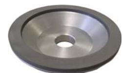
Mola **diamantata legante resinoide**, forma 12 A 2 /45°, per la **rettifica e affilatura** di utensili, il legante resinoide permette lavorazioni sia a secco che con refrigerante.
