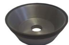
Mola **diamantata legante resinoide**, forma 11 V 9, per la **rettifica e affilatura** di utensili, il legante resinoide permette lavorazioni sia a secco che con refrigerante.
